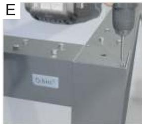
Je nach Motorlage ist in einem der hinteren Stützpfosten eine Verteilerdose zu montieren, um an das bauseitige Stromnetz angeschlossen zu werden (Abb. A). Die Zuleitung kann von unten durch den Stützpfosten geführt werden oder direkt von oben durch die Abdeckplatte.
