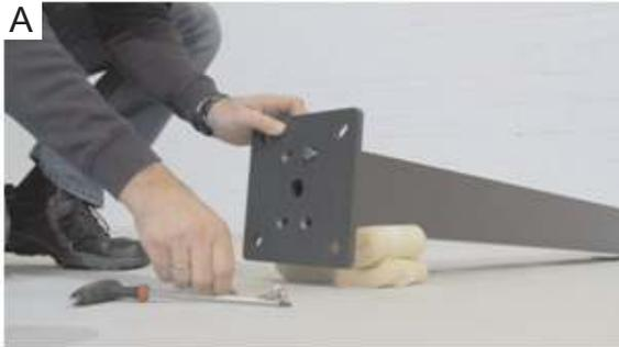
Montieren Sie die Bodenplatten (Abb. A) mit je 4 Senkschrauben M8x25 an die vorderen Stützpfeiler rechts und links. Die Profile tragen Aufkleber zur Orientierung. Schrauben entnehmen Sie aus der Schraubenbox.
