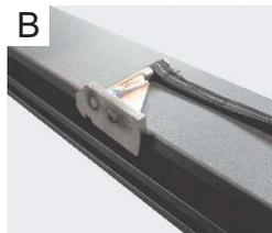
Führen Sie das Zugband innerhalb der Führungsschiene von unten über die untere Umlenkrolle zurück zum Ausfallprofil (Abb. A) und stecken Sie die Öse in den Zughaken (Abb. B). Schieben Sie den Zughaken in die vorgesehene Gasse des Ausfallprofils bis zum Anschlag (Abb. C), der Schnappverschluss macht hier ein deutliches Schnapperäusch. Die Zugbandspannung sollte ca. 200mm - 600mm betragen.
